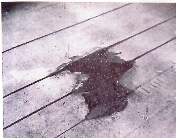
Detta foto visar det Porcellabehandlade trägolvet efter det brandbomben bränt sig igenom. Golvet bestod av 3/4 " ospåntad plan på 8 \times 3 " bjälklag.
